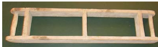
Typisk murstensform. Normalt var der plads til to mursten i formen. Der kunne godt fås forme til tre sten, men så blev formen tungere at håndtere. Foto stillet til rådighed af Verner Bjerger, Horsens.
