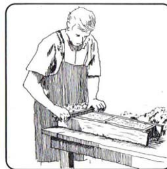
Typisk murstensform. Normalt var der plads til to mursten i formen. Der kunne godt fås forme til tre sten, men så blev formen tungere at håndtere. Foto stillet til rådighed af Verner Bjerger, Horsens.
